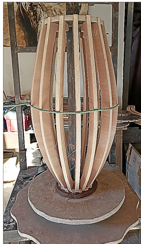
Une méthode de travail qui permet de réaliser de grandes jarres à l'aide d'un gabarit en bois.
